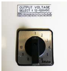
ซีเลคเตอร์หมุนปรับแรงดันได้ถึง 10 STEPS (อยู่ด้านบน)
